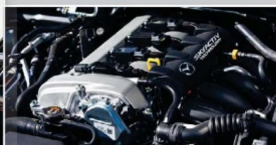
**Motores:** 4 cilindros en línea, inyección directa, gasolina
